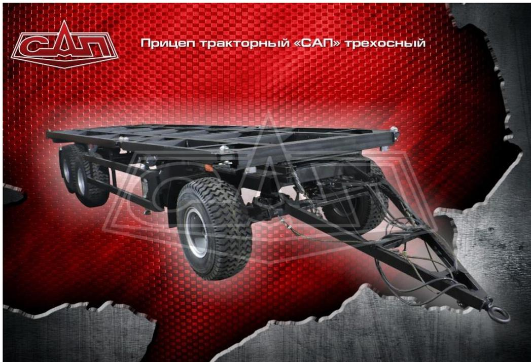
Тракторные прицепы шасси выпускаются на базе высококачественных осей с шириной колеи 2030 мм. Тракторные прицепы могут изготавливаться на неразборных или разборных дисках. Прицепы шасси могут комплектоваться шинами КФ-105А или КФ-97 (камерный или бескамерный вариант).
