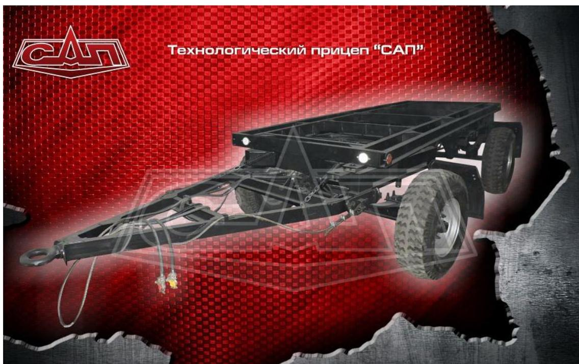
Технологические прицепы шасси "САП" ("технологички") предназначены для установки на них: технологических емкостей, ДГУ (дизельных генераторных установок) и прочего оборудования, требующего повышенной грузоподъемности.
