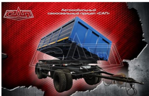
Автомобильные самосвальные прицепы (прицепы-самосвалы) "САП-84611Р" предназначены для перевозки различных сельскохозяйственных грузов, в т.ч. минеральных удобрений, а также сыпучих строительных грузов по всем видам дорог и в полевых условиях, если состояние грунта обеспечивает нормальную проходимость автопоезда.
